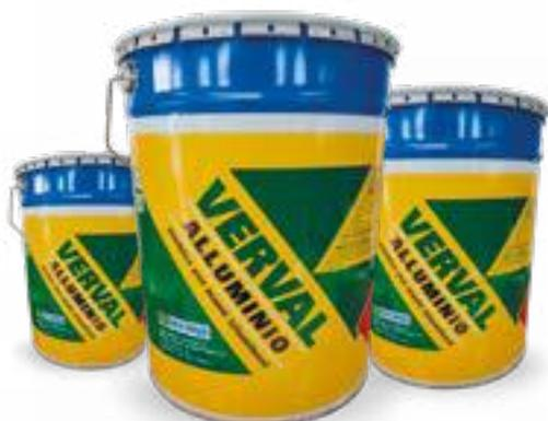
**DESCRIZIONE** Prodotto bituminoso con alluminio a base solvente, usato come protettivo e decorativo per membrane b.p. nuove e vecchie. Ad essiccazione avvenuta, forma una pellicola che riflette i raggi solari apportando un contributo apprezzabile all'isolamento termico delle parti protette. Non cola alle alte temperature ed è sufficientemente plastico da seguire i movimenti e le dilatazioni delle membrane b.p. sottoposte alle più severe escursioni termiche.
