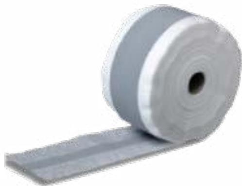
**DESCRIZIONE** Banda coprigiunto impermeabile da utilizzarsi in abbinamento a IDROVAL ELASTIC, LIQUIGUM PLUS, la gamma delle guaine liquide impermeabili e rivestimenti cementizi polimero modificati. È costituita da una banda di copolimero termoplastico rinforzato da tessuto non tessuto. Il prodotto garantisce praticità e semplicità d'impiego, totale impermeabilità all'acqua, buona elasticità ed elevata capacità di allungamento, ottima adesione grazie al TNT ed alle fasce laterali forate.
