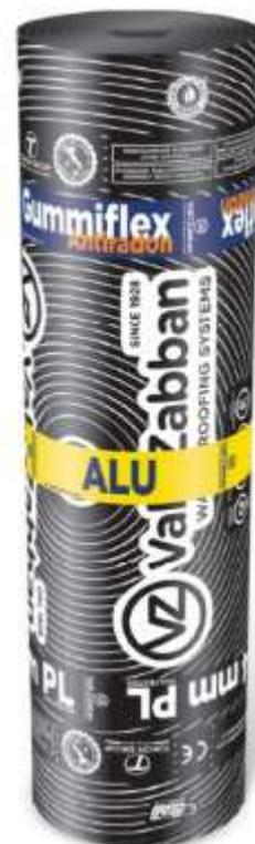
**Descrizione** Membrana impermeabile con funzione di barriera ai gas, VOC's, radon e barriera contro la risalita di umidità, in bitume modificato con polimeri elastoplastomerici e armatura composita ALU, conforme secondo EN13969 per fondazioni e opere interrata. Barriera vapore secondo EN 13970.
