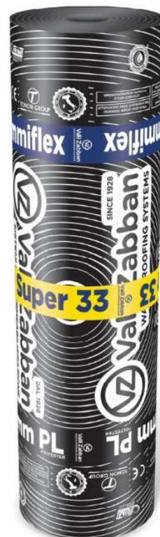
**Descrizione** Membrana ad elevate prestazioni realizzata a partire da bitume distillato modificato con polimeri elastoplastomerici e armatura in poliestere rinforzato-stabilizzato, conforme secondo EN13707 per coperture piane, secondo EN13969 per fondazioni e secondo EN14695 per ponti ,viadotti, coperture carrabili.
