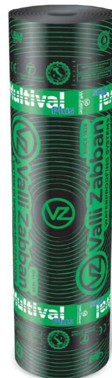
**Descripción** Membrana de betún multicompuesta APAO/SBS de alto rendimiento con armadura de poliéster reforzado-estabilizado. La parte superior de la membrana está formada por un compuesto de betún modificado con poliolefinas APAO, y la parte inferior por un compuesto elastomérico SBS.
