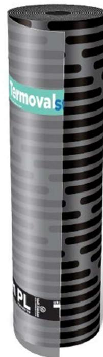
**Descrizione** Membrana adesiva in bitume modificato con polimeri elastoplastomerici ad elevate performance e armatura in poliestere filo continuo rinforzato-stabilizzato per lavori nuovi e rifacimenti. La parte inferiore è provvista di una finitura con strisce adesive.
