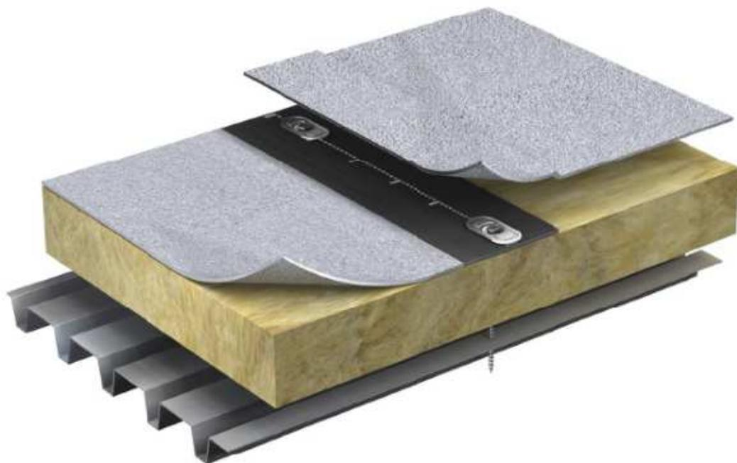
Il sistema di copertura è destinato ad opere nuove. Adatto per coperture con lamiera grecata in acciaio autoportante.
