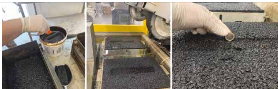
16. La preparazione delle lastre bistrato ed esecuzione del test di ormaimento
