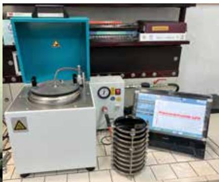
Strumentazione per prova PAV
