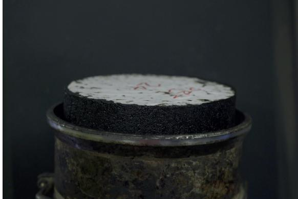
R&D e testing alla base dell'innovazione Valli Zabban (a sx: prova DSR; a dx carota di CB con bitume modificato con polimeri a lunga durata Drenoval PBT)
