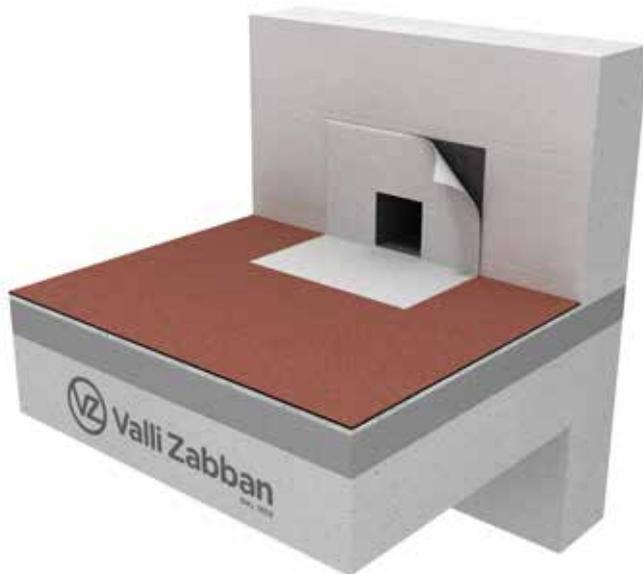
5. Posare l'armatura VZ TECHNO MAT restando più larghi di 5 cm rispetto alla flangia del bocchettone e praticare un foro in corrispondenza dello scarico.
