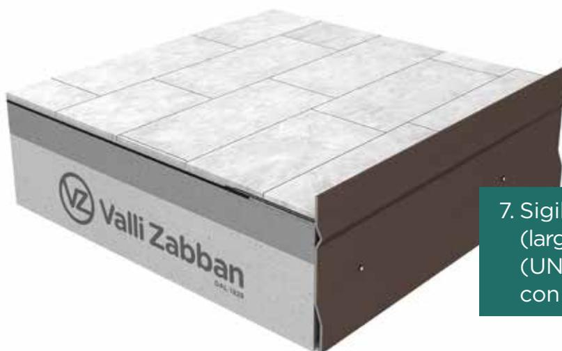
7. Sigillare le fughe tra le piastrelle (larghezza 2-3 mm) con sigillante a stucco (UNI EN 13888-1). Utilizzare piastrelle con buona stabilità dimensionale.
