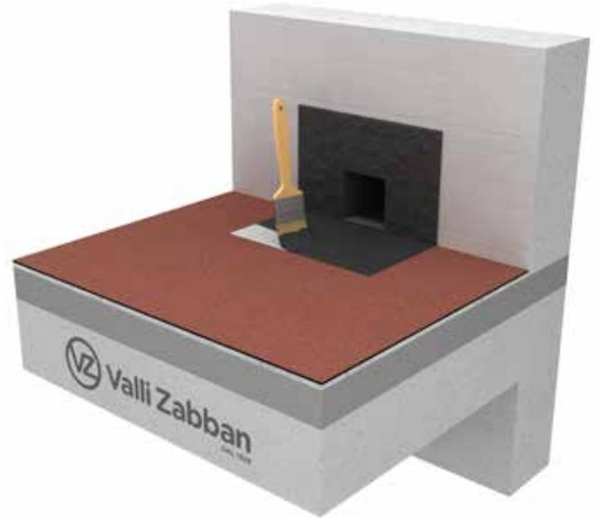
6. Applicare VALPUR FAST o IDROVAL COATING sul quadrato di armatura VZ TECHNO MAT.
