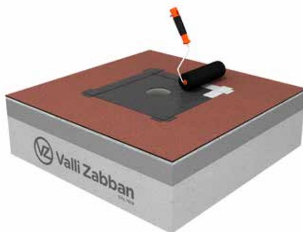
8. Applicare VALPUR FAST o IDROVAL COATING sulle 4 strisce di VZ TECHNO MAT.
