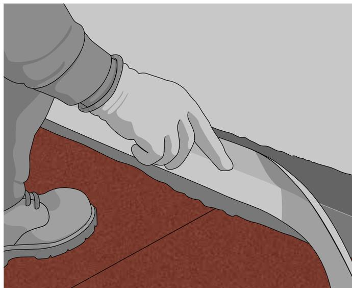
1. Applicare una prima mano d'impermeabilizzazione liquida **VALPUR FAST** per una fascia di 10 cm sia in verticale che in orizzontale.
