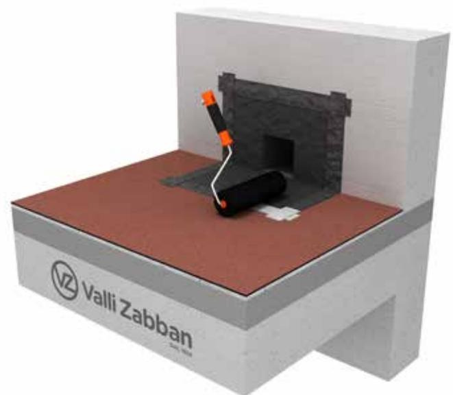
8. Applicare VALPUR FAST o IDROVAL COATING sulle 4 strisce di VZ TECHNO MAT.
