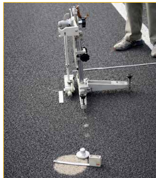
Fig. 10. La prova di aderenza con pendolo
