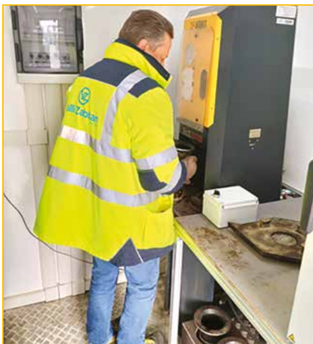
Fig. 9. La compattazione con pressa giratoria su laboratorio mobile
